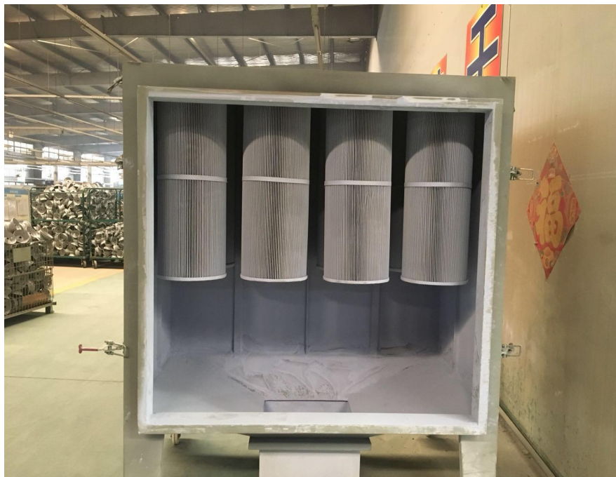
图 4--1-3 静电喷涂废气净化设备
