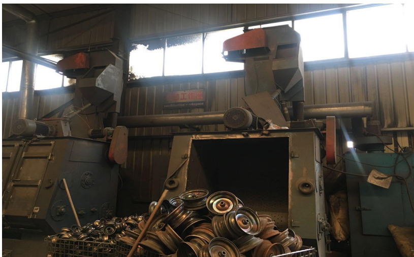
图 4--1-2 打砂废气净化设备
